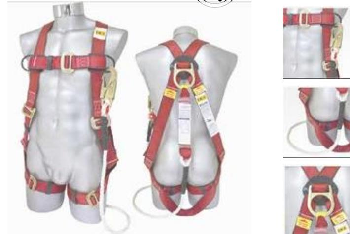
Arnés con anillo "D" en la espalda y amortiguador de impacto con cable de cuerda nylon de 1/2" de diámetro. *Item: K-SAR*. Básicamente un artículo que combina los atributos del ARN-L y el C-ARN-L. Estos equipos deben ser conectados a estructuras que son capaces de resistir 2,268 Kg. ANSI-359.1-1992
